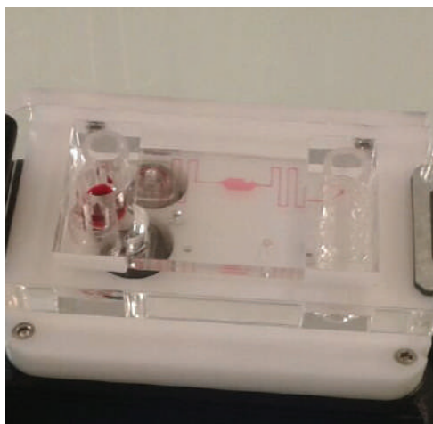
Réacteur microfluidique pour analyse de liquides biologiques
